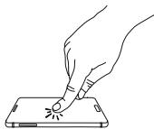
Przyciśnij środek szkła- to pomoże mu dokładnie przywiązać do ekranu.
